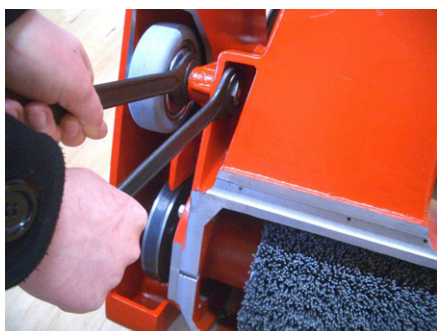
III. Justering av av børstetrommel
